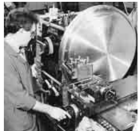
Figura 5 – Lavorazione del coperchio di rame[8]
