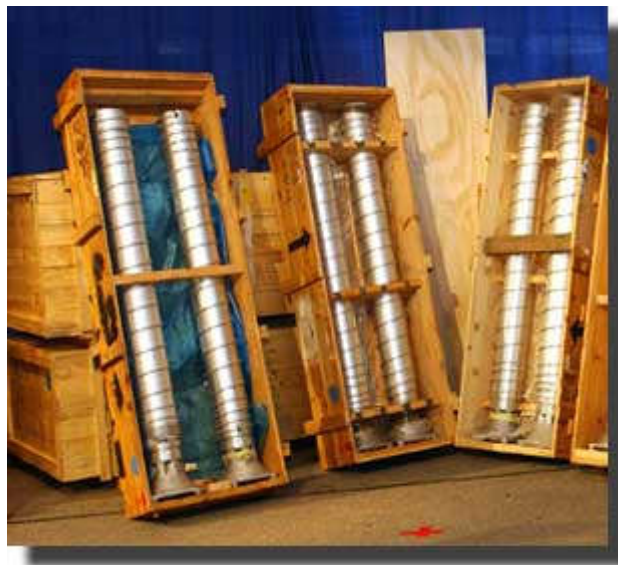
Figura 4 – Ultracentrifughe per l'arricchimento dell'uranio acquistate che la Libia ha acquistato dal 'mercato nero nucleare' del dott. Khan
