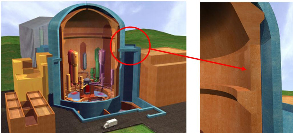
Fig.12 – Dettagli dell'edificio di contenimento del reattore EPR
