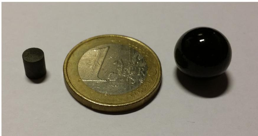
Fig.8 - Confronto delle dimensioni di una pasticca di combustibile nucleare per reattori veloci (dalle dimensioni di 4,9 (diametro) x 5,7 (altezza) mm, capace di erogare una energia pari a 3 tonnellate di carbone o 2000 litri di benzina), una sfera di scorie vetrificate (dal diametro di circa 12 mm, pari al volume prodotto da una famiglia per i propri bisogni energetici in un anno) e una moneta da 1 euro
