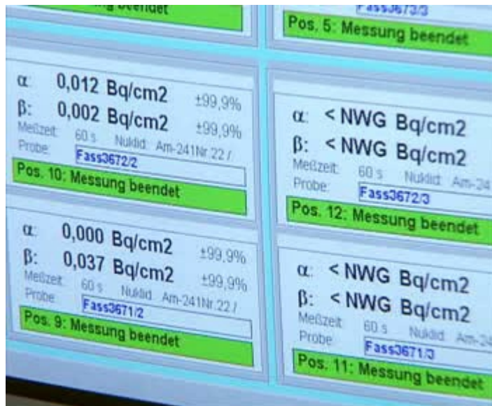
Fig.8 – Valutazione della contaminazione superficiale dei campioni (fonte: “The Kahl nuclear power test plant – Dismantling the reactor building”, NUKEM GmbH)
